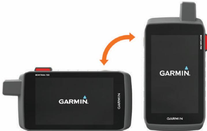
**ПРИМЕЧАНИЕ.** при использовании функций inReach устройства Montana 700i/750i необходимо использовать устройство в вертикальном (книжном) режиме, чтобы антенна была направлена в сторону неба.
